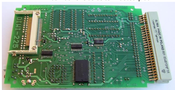
DivIDE Plus Platine: Unterseite mit CF-Kartensteckplatz
